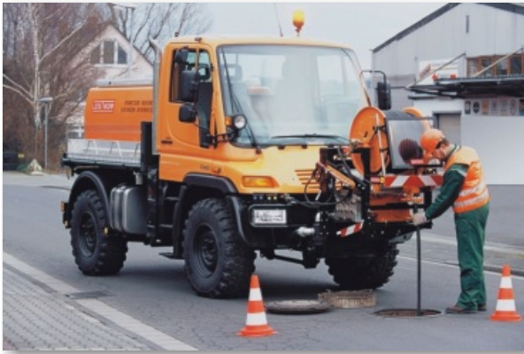
ΑΠΟΦΡΑΚΤΙΚΟ ΜΗΧΑΝΗΜΑ (UNIMOG) Όγκος δεξαμενής max 3.000 lt Απόδοση αντλίας: Πίεση max 102 lt/min σε max 150 bar
