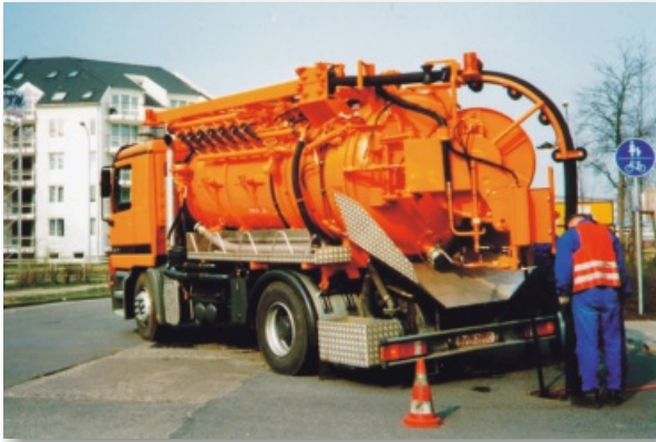
ΜΙΚΤΟ ΜΗΧΑΝΗΜΑ ΚΑΘΑΡΙΣΜΟΥ Αναρρόφησης - Απόφραξης Όγκος δεξαμενής 3.000 - 10.000 lt Απόδοση αντλίας: Πίεση 180 - 330 lt/min σε max 150 bar Αναρρόφηση max 1500 m 3 /h σε 200 mbar
