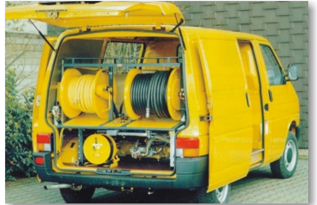
ΜΙΚΡΟ ΑΠΟΦΡΑΚΤΙΚΟ ΜΗΧΑΝΗΜΑ Όγκος δεξαμενής νερού max 600 lt Απόδοση αντλίας: Πίεση max 100 lt/min σε max 200 bar
